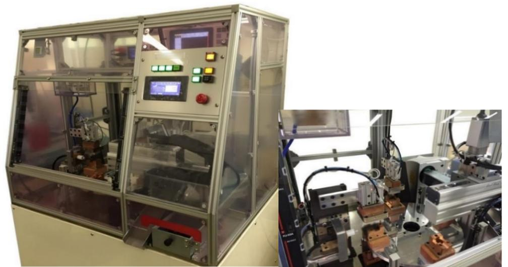
車載部品電気特性検査装置
