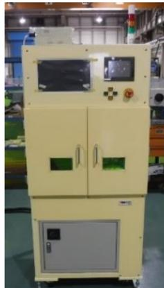
**電子部品レーザー溶接装置**
