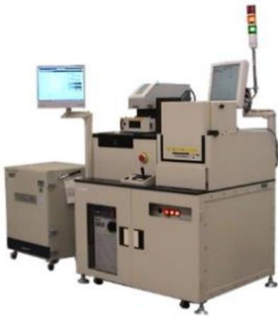
**W-CSP用 レーザマーク装置**
