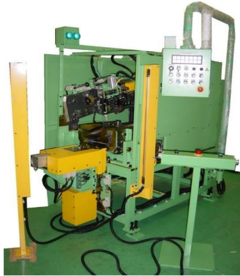
円筒型ワーク向け 直線TIG溶接装置
