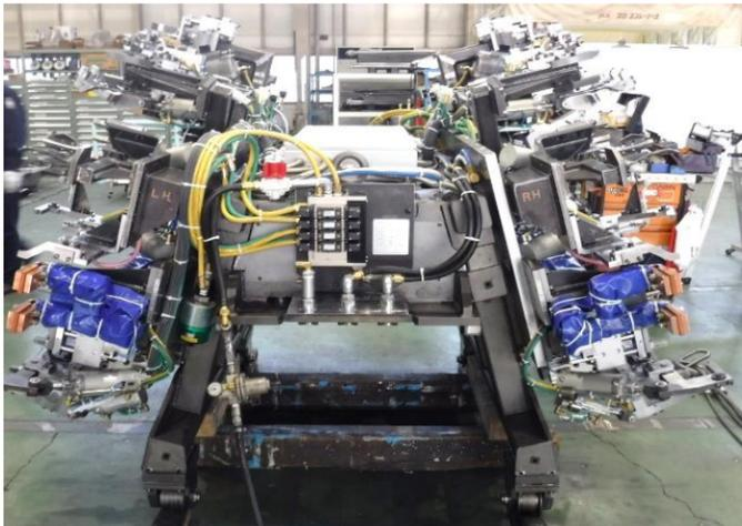
車体サイドパネル ロボット溶接治具
