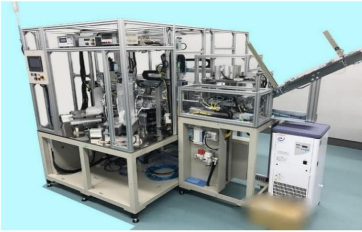
車載部品組み付け溶接装置
