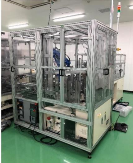
**電子部品反転移載装置**
