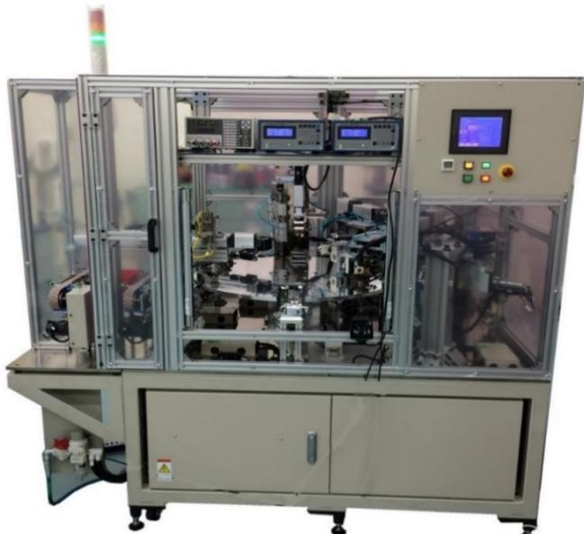
ターンテーブル式車載部品溶接装置
