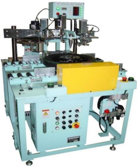
オートバイ用タイヤ振れ検査装置
