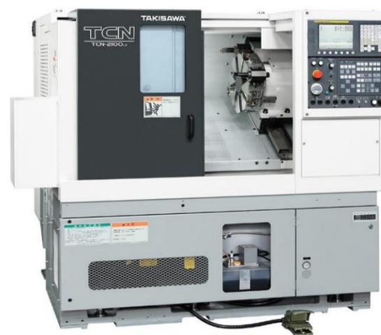
CNC精密自動旋盤(滝澤鉄工所)
