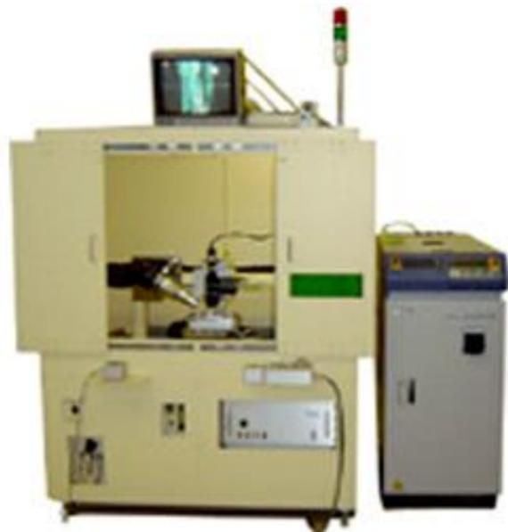
**二次電池向けレーザー溶接装置**
