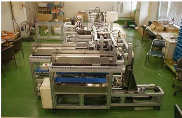
**電子部品外観検査装置**
