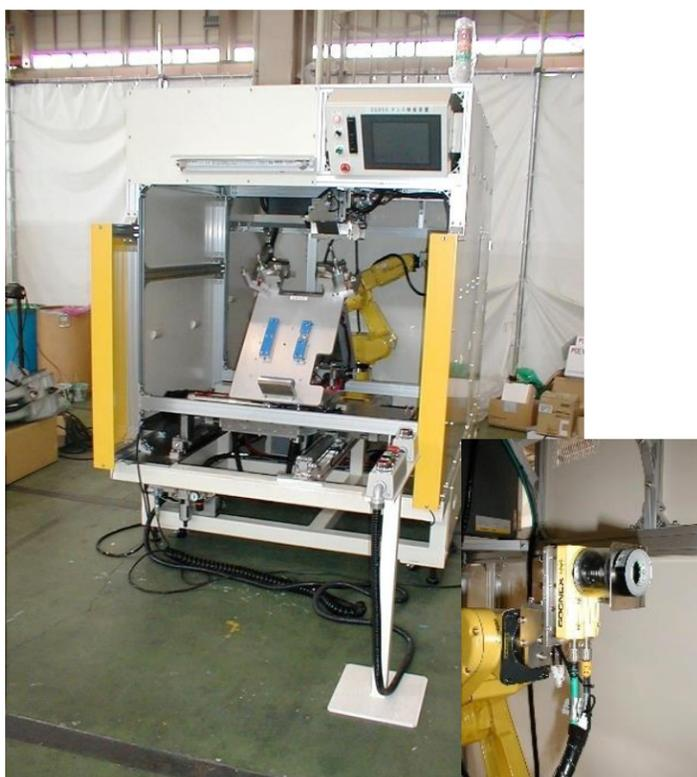
自動車部品外観検査&2Dコード刻印装置
